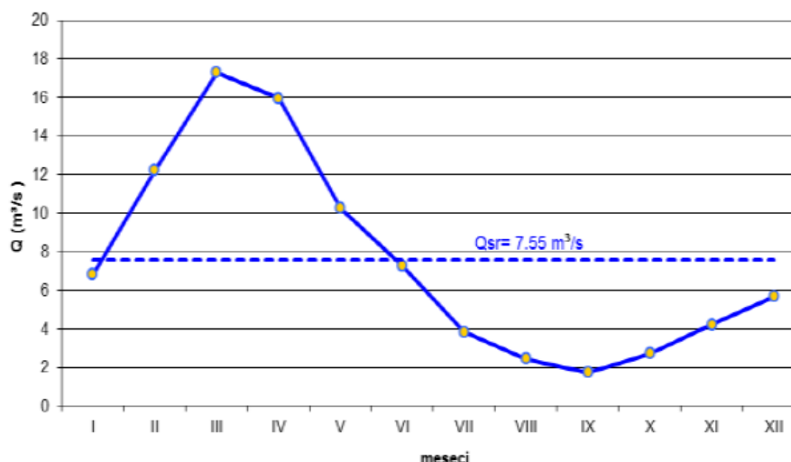
Слика 10. Дијаграм средњих месечних протицаја реке Пек (м 3 /с) на водомерној станици „Кучево“ за период 1954-1991. (РХМЗ Србије)
